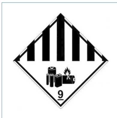
Abbildung 5: Gefahrgutkennzeichnung für Lithium-Ionen-Batteriesysteme
