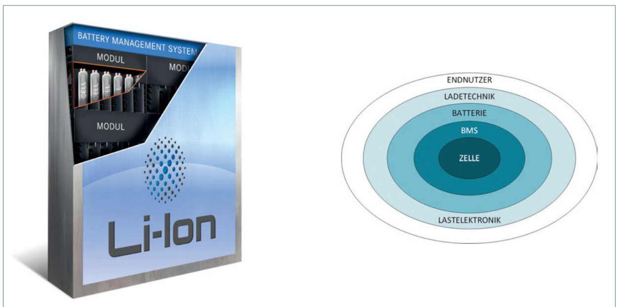
Abbildung 3: Beispielhafter Aufbau eines Lithium-Ionen-Batteriesystems und schematische Sicherheitsabbildung
